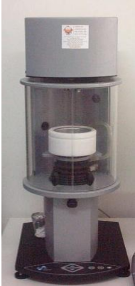
Şekil 3.4: Du Nouy gerilim ölçer
