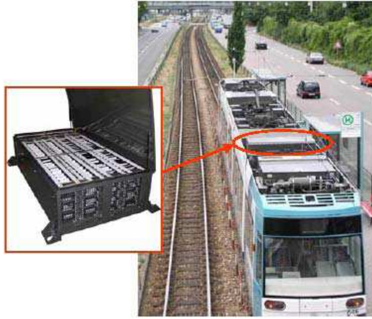
Şekil 3.1: Araç üstü enerji depolama örneği.
