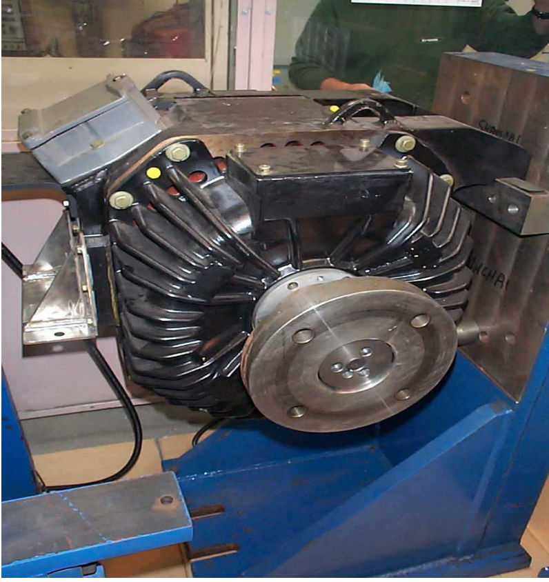
Şekil 2.29: Hyundai-Rotem metro araçlarında kullanılan cer motoru.
