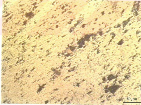
Şekil A.65 1050°C'ta 8 saat sinterlenen 85W15Cu bileşiminde W1 ve Cu1 tozlarından hazırlanan (EM15 kalın) numunesine ait mikroyapı görüntüsü.
