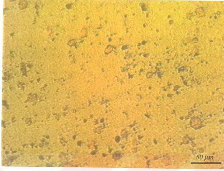
Şekil A.64 1050°C'ta 1 saat sinterlenen 85W15Cu bileşiminde W1 ve Cu1 tozlarından hazırlanan (EM15 kalın) numunesine ait mikroyapı görüntüsü.
