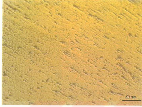
Şekil A.66 1050°C'ta 1 saat sinterlenen sinterlenen 85W15Cu bileşimde atritörde 8 saat öğütülmüş A158 numunesine ait mikroyapı görüntüsü.
