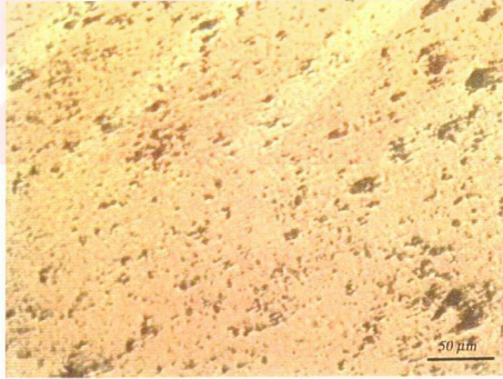
Şekil A.63 1050°C'ta 8 saat sinterlenen 85W15Cu bileşiminde W2 ve Cu2 tozlarından hazırlanan (EM15 ince) numunesine ait mikroyapı görüntüsü.
