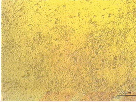
Şekil A.68 1050°C'ta 1 saat sinterlenen 85W15Cu bileşimde düzlemsel bilyalı değirmende 8 saat öğütülmüş B158 numunesine ait mikroyapı görüntüsü.
