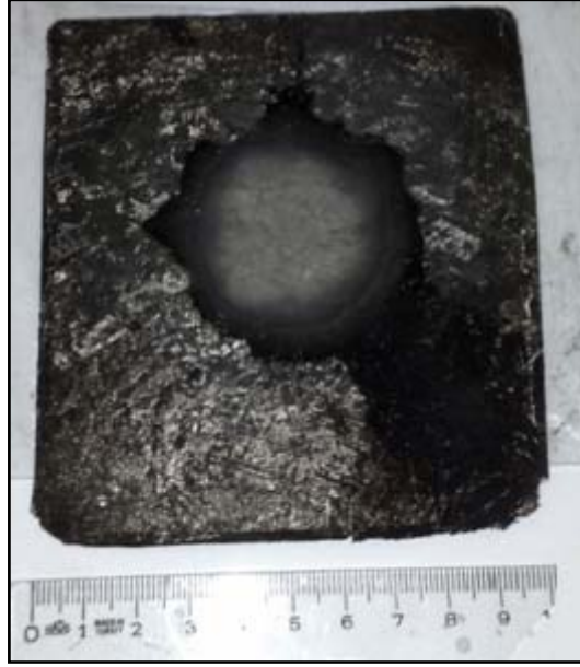
Şekil 7.6 : Dinamik ısı akısı test sonucu K06 kompozitinin yüzeyinde kömürleşen bölge gri tonlarda, pirolize uğrayan bölgeler ise parlak olarak gözükmekte ve birbirinden ayrılmaktadır.
