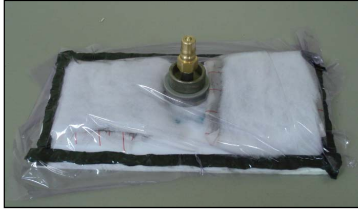
Şekil 7.4 : Vakum aparatlarıyla sarılmış numune
