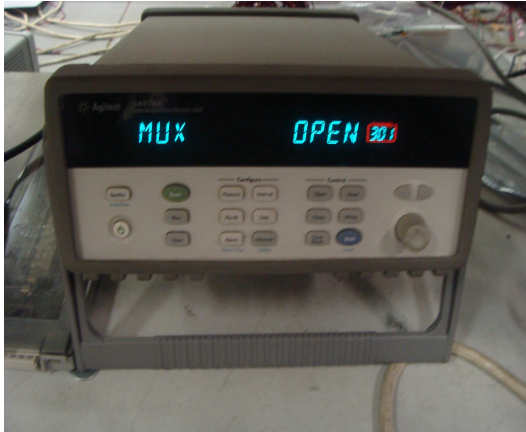
Şekil 3.5: Veri toplama cihazı ve termokupl fiş ve priz panosu
