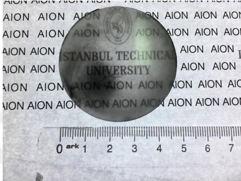
Şekil 4.14 : Ağ. %0,4 \text{CaCO}_3 katkılı, 1650 °C’de, 50 °C/dk ısıtma hızında, 40 MPa basınçta elde edilen numune (AION2-5).
