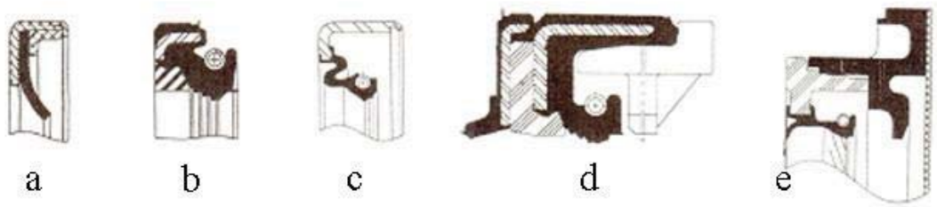
Şekil 2.8 : Ekstrem durumlarda kullanılan keçeler.
