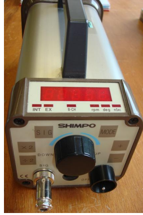
Şekil 2.1 : Motor devrinin ölçümünde kullanılan ölçüm aleti “Stroboscope”.
