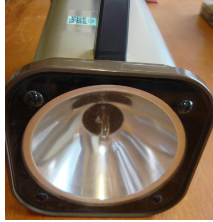
Şekil 2.1 : Motor devrinin ölçümünde kullanılan ölçüm aleti “Stroboscope”.
