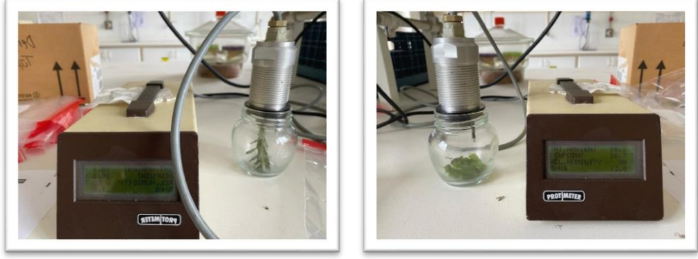
Şekil 3.4: Su aktivitesi ölçüm cihazı (Protimeter, PLC, İngiltere).
