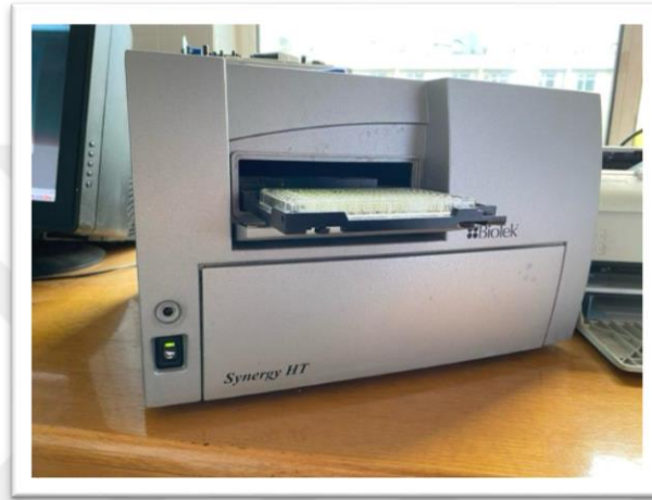
Şekil 3.5: Spektrofotometre (Biotek Synergy HTX Multimode Reader).
