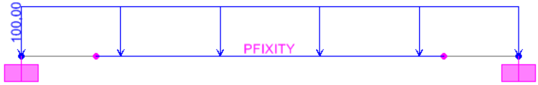
Şekil D.5 Her iki ucuna birleşimin yay katsayıları girilmiş kirişe etkiyen düşey yük
