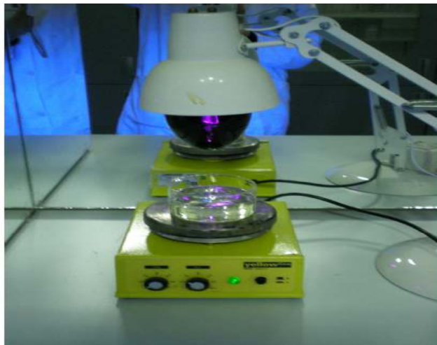
Şekil 3.2 : Foto-Fenton-benzeri prosesi deney düzeneği.
