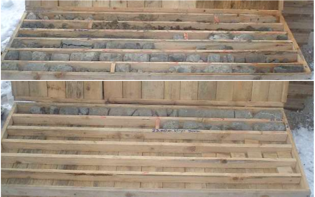
Şekil 4.4: Sağ tüp güzergahı üzerinde açılan, SK-1 sondajı karot sandığı
