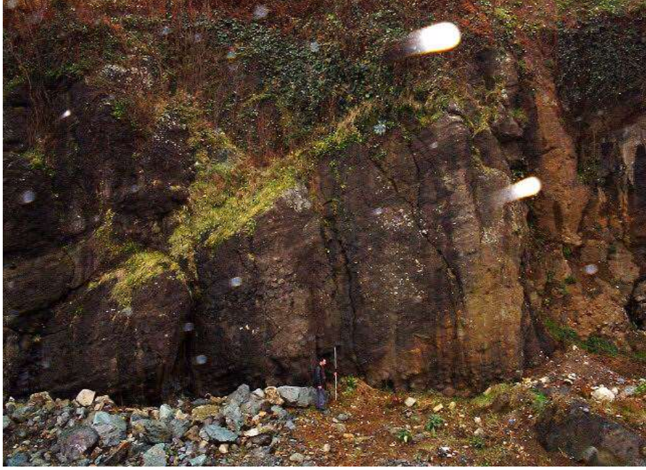
Şekil 4.17: Km 163+200 – 163+220 'ler arasında bulunan 18^{\circ} KD eğimli akma yapısı.
