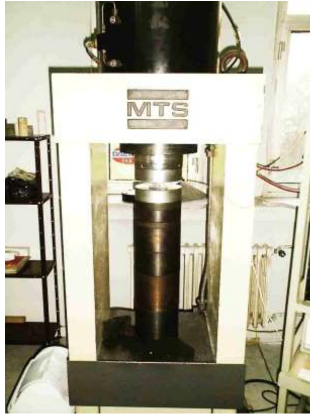
Şekil 4.11: MTS aletinde yapılan İndirekt Çekme Drenç Deneyi
