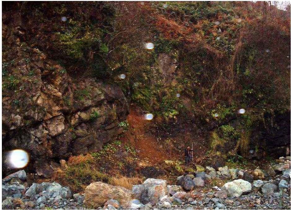
Şekil 4.18: Km 163+228 – 163+233 'ler arasında bulunan kil dolgu ezi k ve fay zonu.
