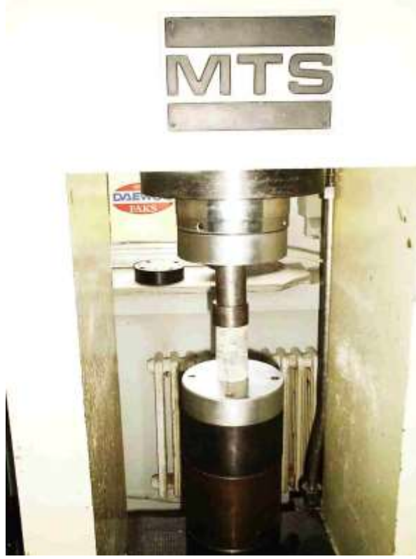
Şekil 4.10: MTS aletinde yapılan Tek Eksenli Basınç Drenç Deneyi
