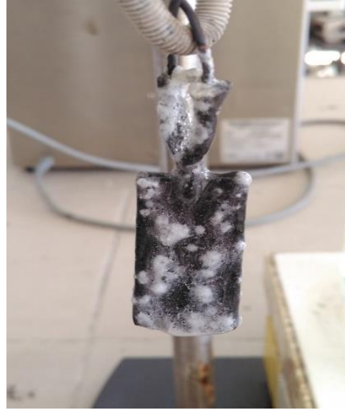
Şekil 4.2: Ergimiş tuz banyosundan çıkarıldıktan sonra üzerinde artık tuz kalan borlanmış numune.
