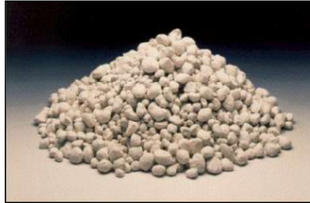
Şekil 2.6 : Soğuma esnasında oluşan çarpılma olayını önleyici kaolin maddesi [7].
