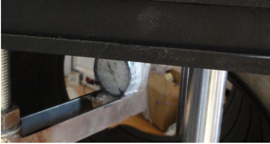
Şekil 6.5 : Test aleti üzerine yerleştirilmiş analog komparatör.
