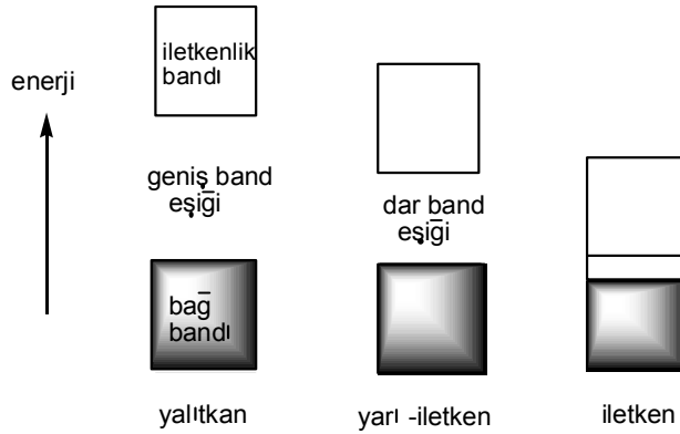
Şekil 2.8 : Yalıtkan, yarı-iletken ve iletken maddelerde band aralığı.
