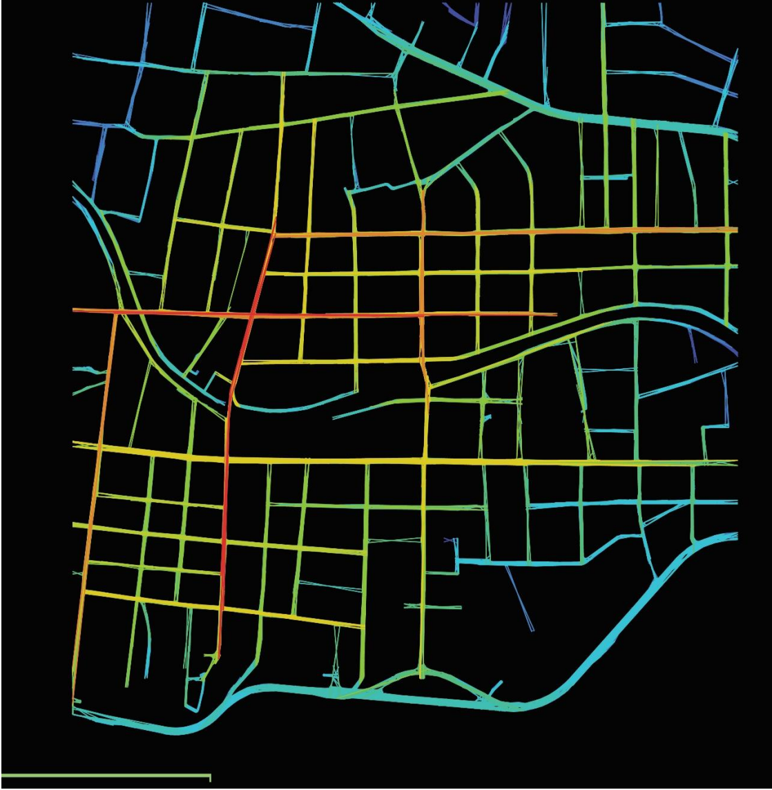
Şekil 4.7 : Depthmap uygulaması kullanarak eksenel (axial) olarak yapılan, bütünleşme (integration) değerini gösteren alan analizi.
