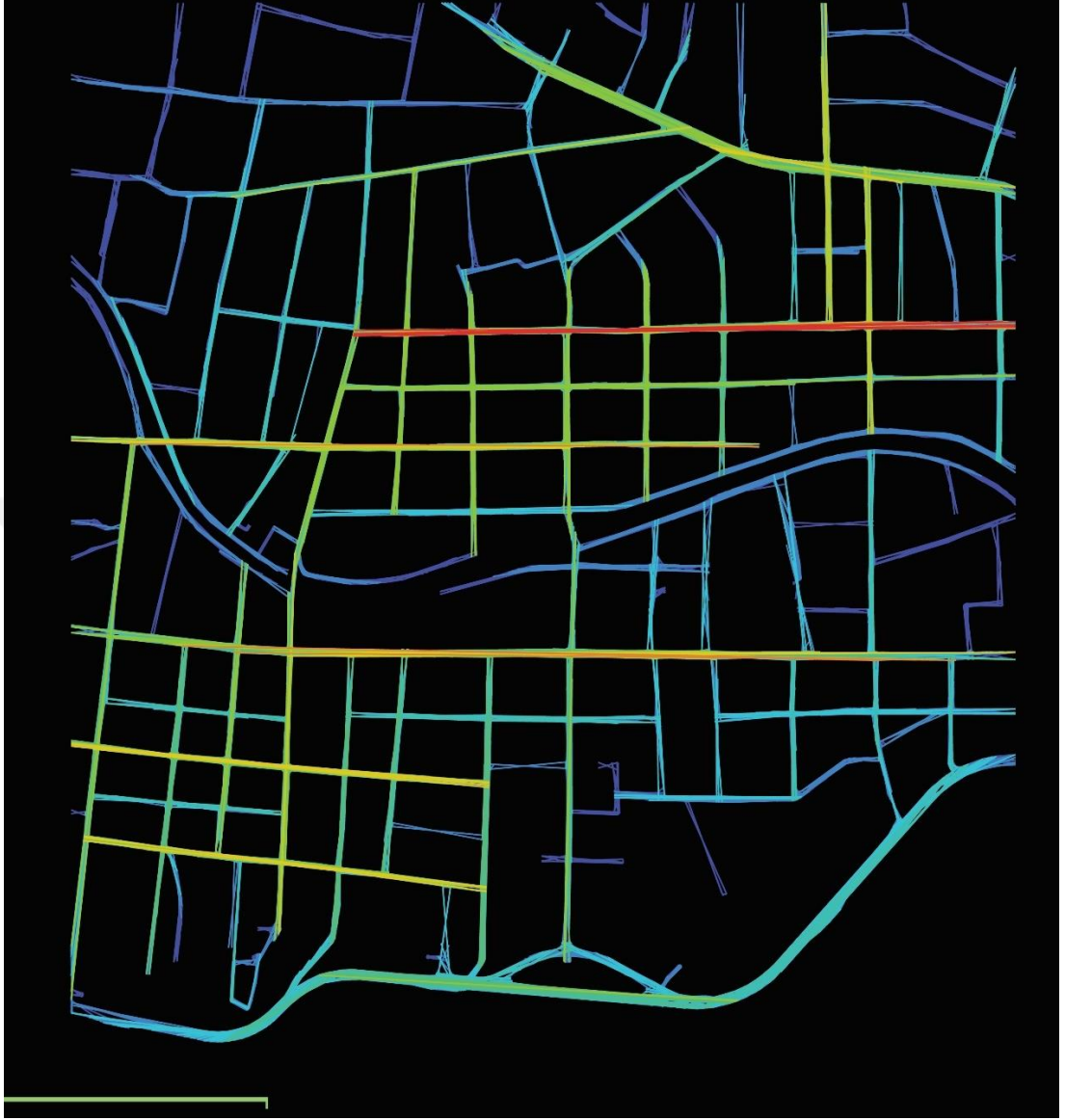
Şekil 4.6 : Depthmap uygulaması kullanarak aksenel (axial) olarak yapılan, bağlantısallık (connectivity) değerini gösteren alan analizi.
