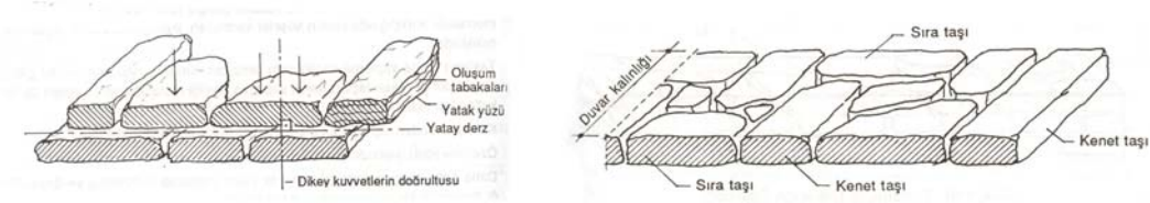
Şekil 5.1. Taş tabakaları, duvardaki konumları ve kenet taşlarının düzenlenmesi [15, s.99]
