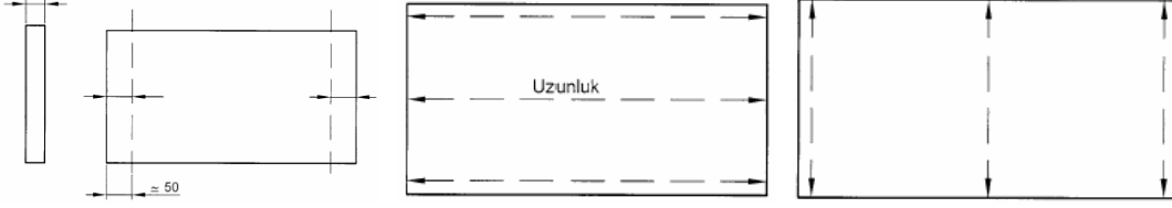
Şekil 5.37. Alçı bloklarda kalınlık, uzunluk ve yükseklik ölçümü [51, s.8]
