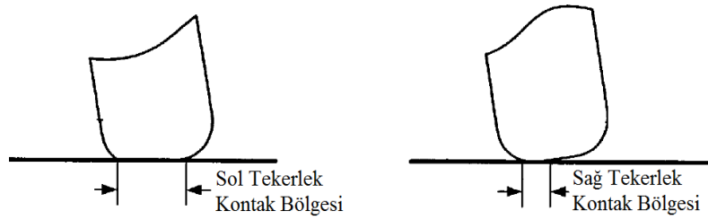
Şekil 1.27 : Sağa dönüş sırasında tekerlek kontak bölgeleri [22].
