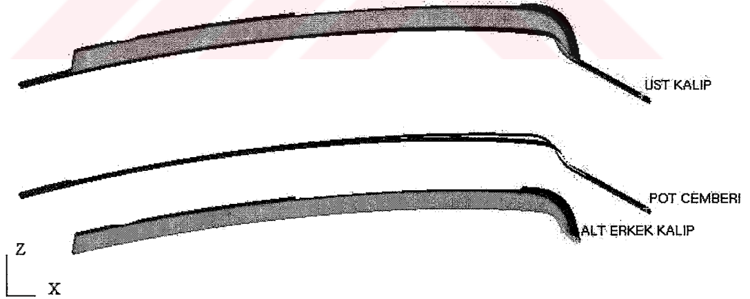
Şekil 3.9: Arka kapı dış panelin çekme kalıbı yüzeylerinin açık halde yandan görünüşü
