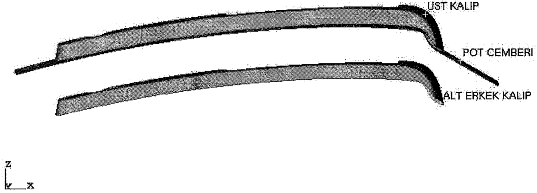
Şekil 3.10: Tutma esnasında kalıp parçalarının konumu
