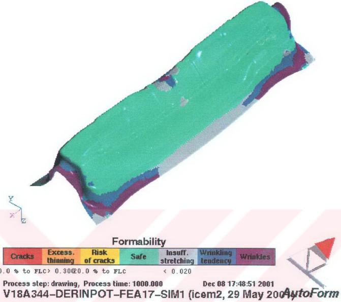
Şekil 3.19: Ön göğüs paneli çekme sonu
