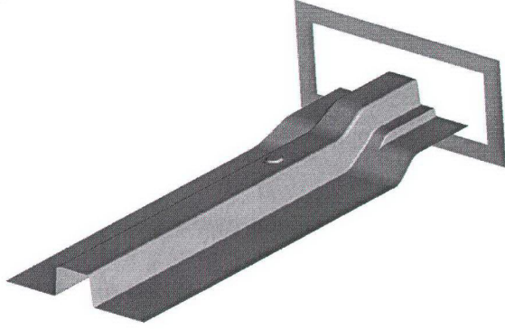
Şekil 3.21: Arka şasi kolu paneli çekme simülasyonu simetri düzlemi
