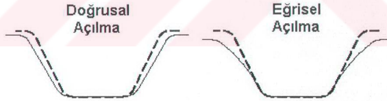
Şekil 5.2: Çeşitli geri yaylanma şekilleri (a) Doğrusal açılma bölgesel bükmelerde görülürken (b) eğrisel açılma genellikle çekme ve bükmenin birlikte olduğu durumlarda görülür.
