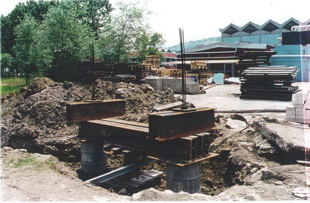
Şekil 11.8. Deneme kolonu üzerinde yapılan yükleme deneyi
