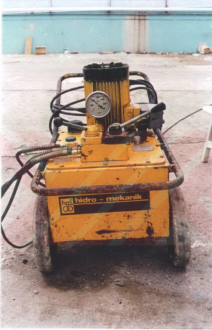
Şekil 11.10 Deneyde kullanılan germe makinesi
