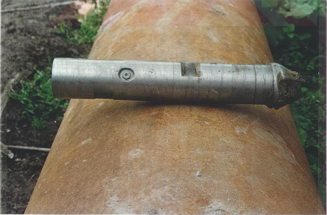
Şekil 4.6. Monitör, enjeksiyon memesi, kil matkabı [20]
