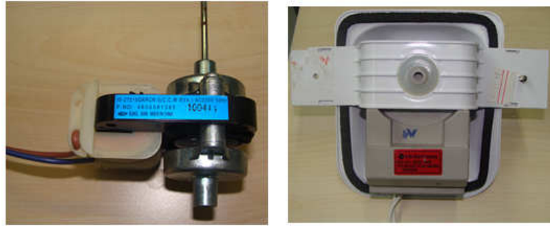
Şekil 3.5 : Deneylerde kullanılan fan motorları; orijinal fan (solda), diğer fan (sağda).
