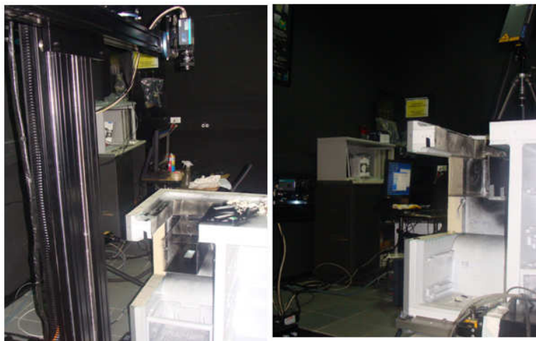
Şekil 5.2 : PIV deney düzenekleri; kamera ile üstten bakış (solda), kamera ile soldan bakış (sağda).
