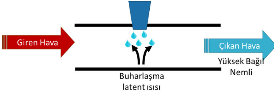
Şekil 2. 1 : Evaporatif soğutma mekanizması.
