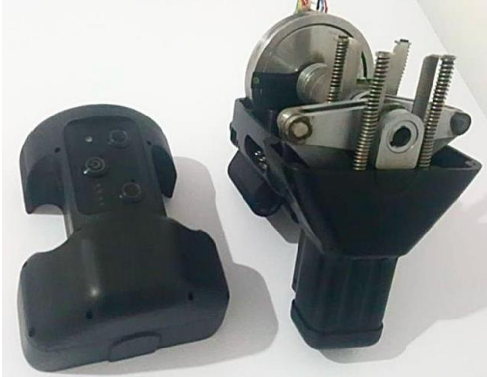
Şekil 4.10 : Üretilen kompresyon modülü.
