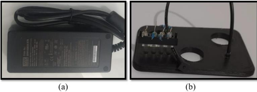
Şekil A.8 : GSM120B20-R7B medikal adaptör (a) ve LED seti (b).
