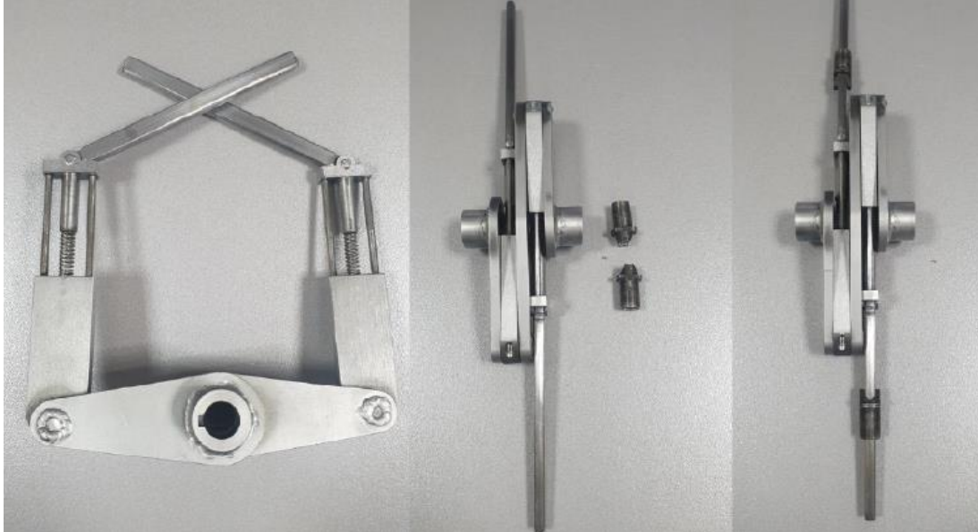
Şekil 4.6 : Çift krank dinamik biyel mekanizması.
