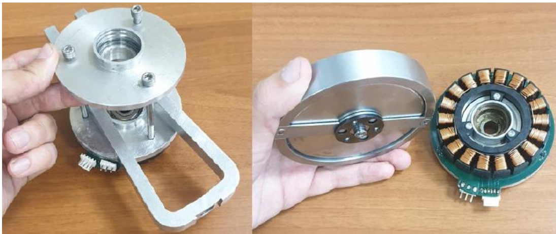
Şekil 4.2 : Motor rotoru sökme aparatı ve motor volan montajı.
