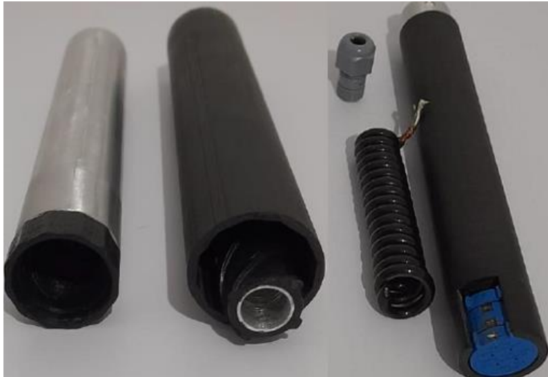
Şekil 4.14 : Doğrusal potansiyometre mekanizması.
