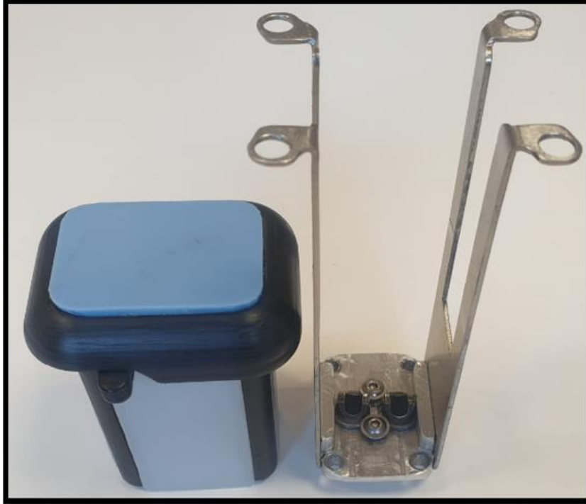
Şekil 4.9 : Piston ve piston üst parçası.
