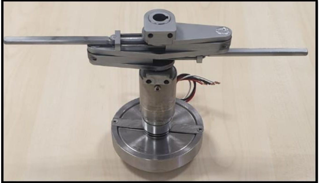
Şekil 4.8 : Kompresyon modülünün iç mekanizma bileşenlerinin montajı.
