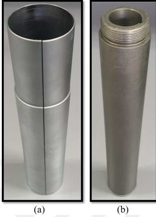
Şekil B.10 : Yarımk burç (a) ve dik kol üst parça (b).
