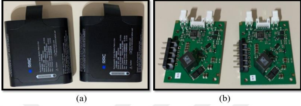
Şekil A.1 : RRC-2054 batarya (a) ve RRC-PMM240 batarya yönetim kartı (b).
