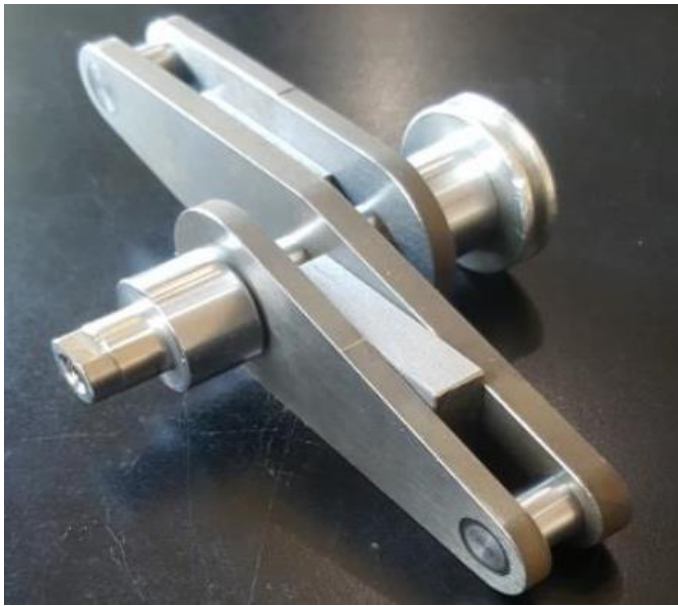
Şekil B.6 : Çift krank ve krank kaynak aparatı (ilk üretim).
