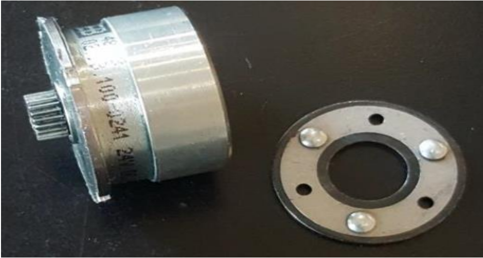
Şekil B.5 : Elektromanyetik kavrama ve kavrama disk.
