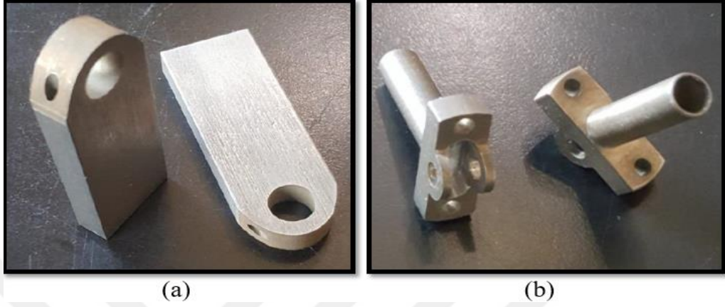
Şekil B.1 : Biyel üst parça (a) ve biyel alt parça (b).
