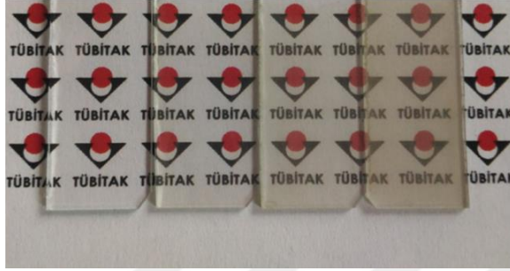
Şekil 2 : Katman katman kaplama metoduyla hazırlanan gümüş nanotellerde hazırlanan saydam iletken elektrotların hazırlanması.
