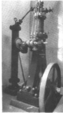
Şekil 2.12: Diesel'in 1893 yılı yapımı motoru [3].
