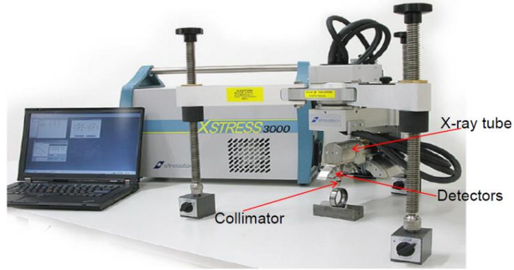
Şekil 6.18 : Stresstech XStress 3000 G2R- XRD cihazı.
