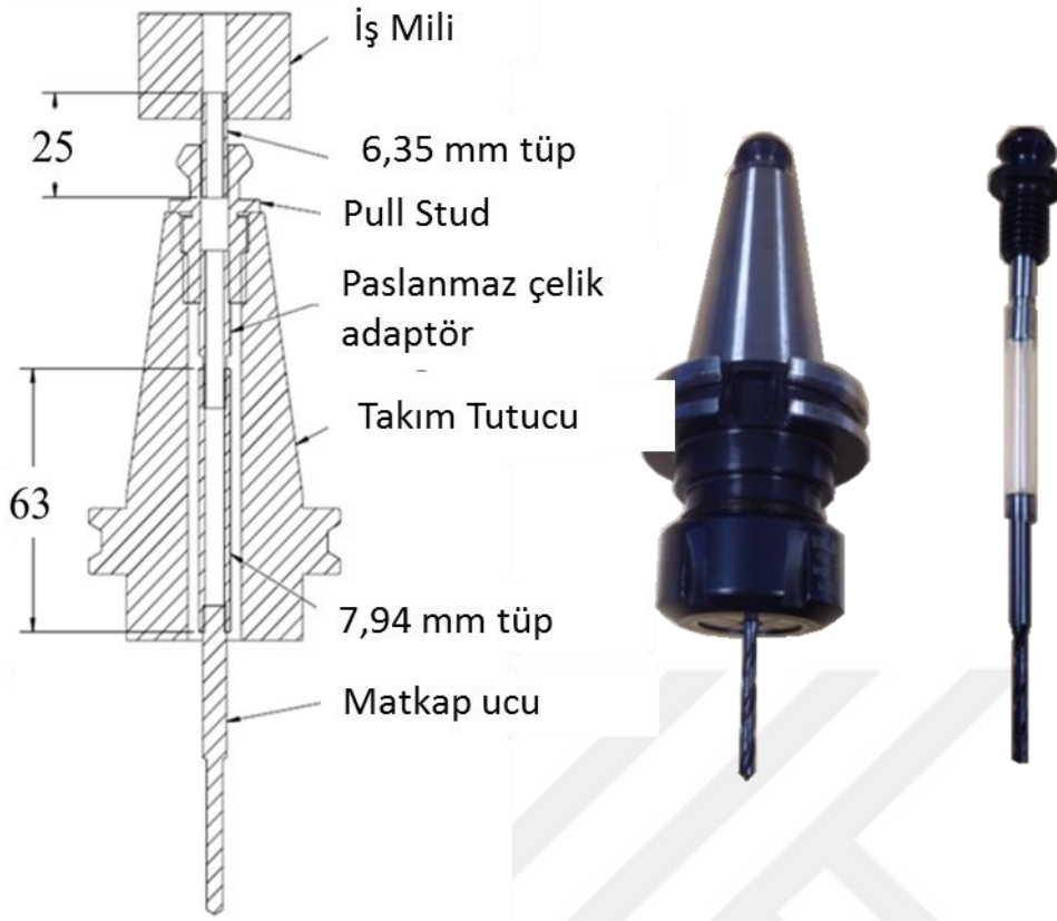
Şekil 6.4 : Modifiye edilmiş takım tutucunun teknik resmi, modifiye edilmiş takım tutucu, ve adaptör ve plastik tüpü bağlantılarının detaylı gösterimi.
