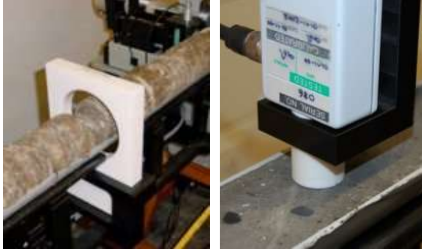
Şekil 2.7 : MS2C Halka (solda) ve MS2E nokta manyetik sensör.
