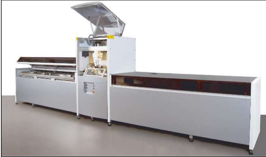
Şekil 2.8 : ITU-EMCOL laboratuvarındaki ITRAX mikro XRF karot tarayıcısı (Croudace v.d., 2006).
