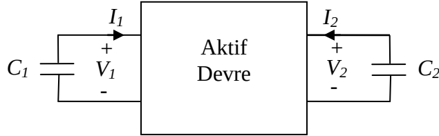
Şekil 2.1: İki kapasite elemanına sahip ikinci dereceden sinüs osilatörü yapısı
