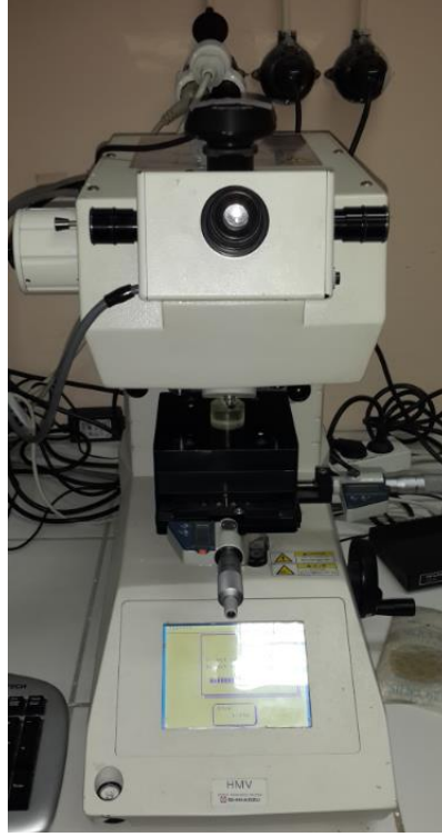
Şekil 4.11 : Borlanmış kesici takımların yüzey sertlik ölçümünde kullanılan Vickers sertlik cihazı.
