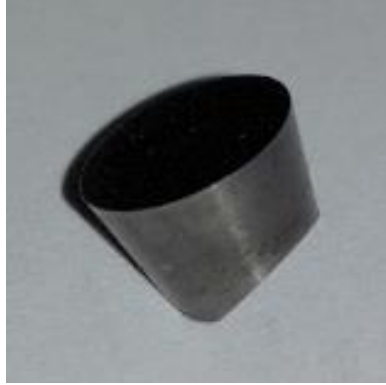
Şekil 4.2 : Borlama deneylerinde kullanılan kesici takım görüntüsü.
