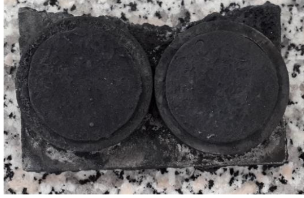
Şekil 4.4 : Etüvde kurutma sonrası borlama düzeneğinin görünüşü.
