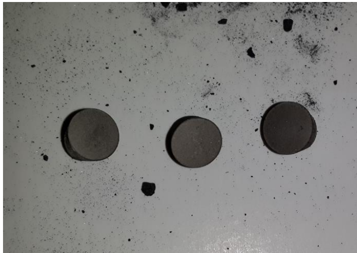
Şekil 4.7 : Pasta borlama sonrası borlanmış kesici takımların görüntüsü.
