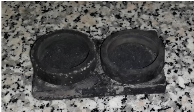
Şekil 4.3 : Borlama deneylerinde kullanılan halkalar ve refrakter.
