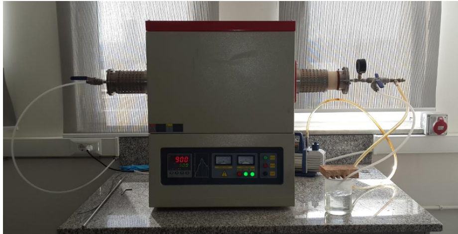
Şekil 4.5 : Borlama işleminin yapıldığı tüp fırın.
