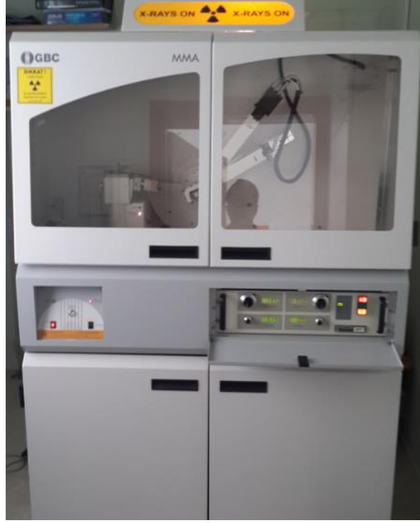
Şekil 4.10 : XRD analizlerinde kullanılan cihaz.
