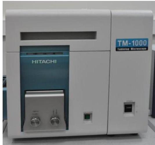
Şekil 4.9 : Borür tabaka incelemesinde kullanılan SEM cihazı.
