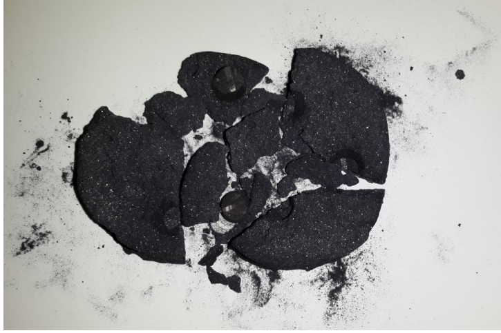
Şekil 4.6 : Borlama sonrası pastanın kırılarak kesici takımların çıkarılması esnasındaki görüntü.
