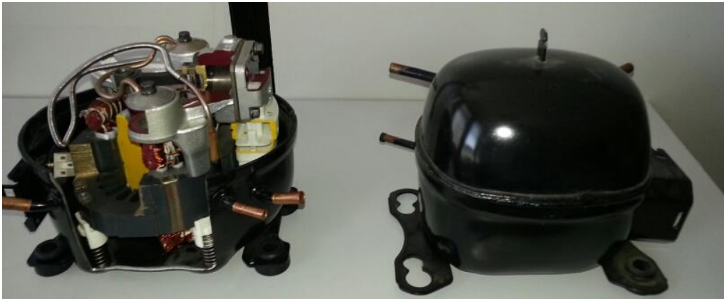
Şekil 2.2 : Muhafaza açık (solda) ve muhafaza kapalı (sağda) kompresör görüntüsü.
