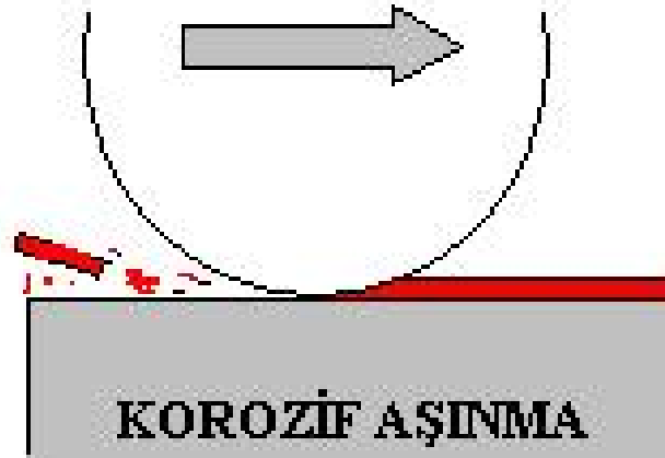
Şekil 3.4 : Korozif aşınma örneği [18].
