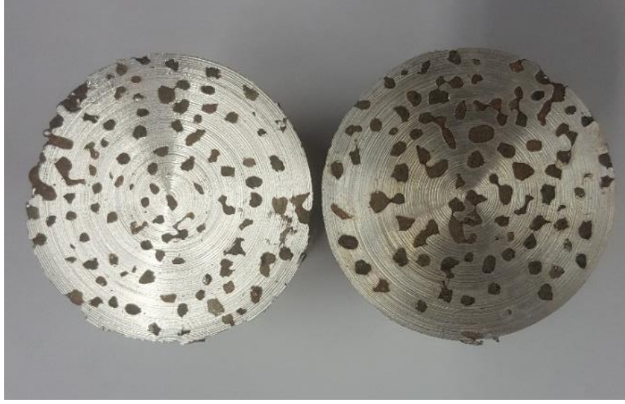
Şekil 4.11: Isıl işlem uygulanmış (sağda) ve uygulanmamış (solda) birer numune (üstten).
