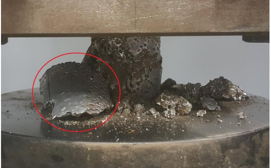
Şekil 4.15: Numune 2'den deney esnasında kopan parça.
