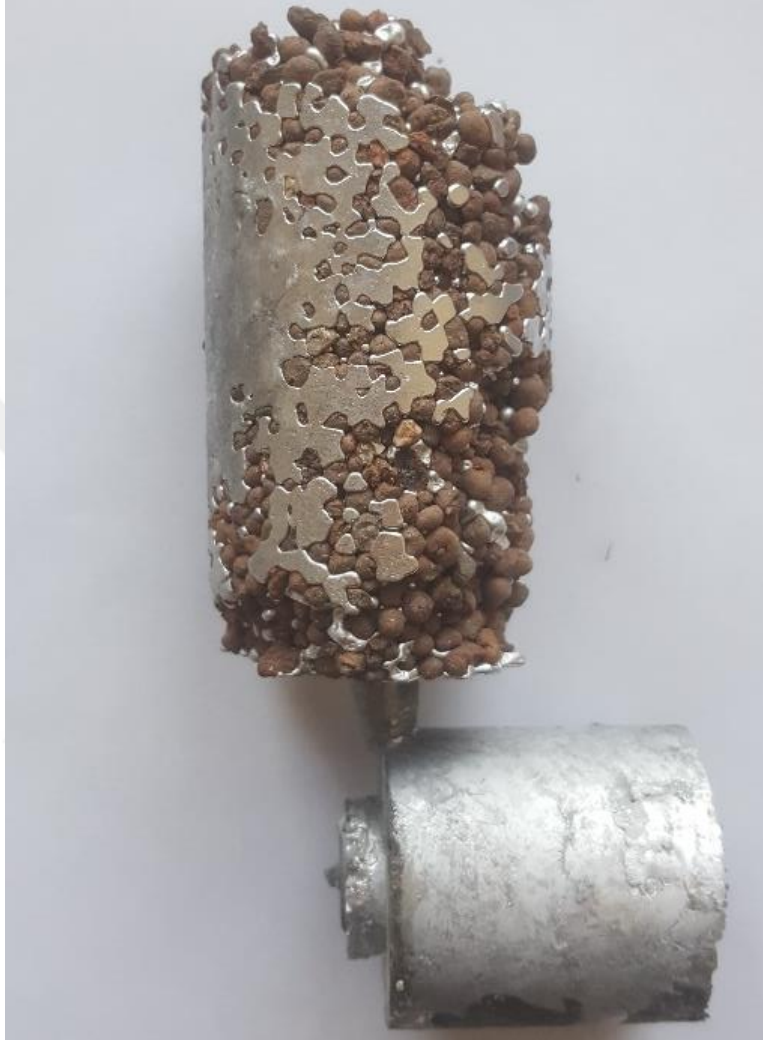
Şekil 4.4: Düşük kalıp sıcaklığından ötürü tam dolum sağlanamamış bir numune.
