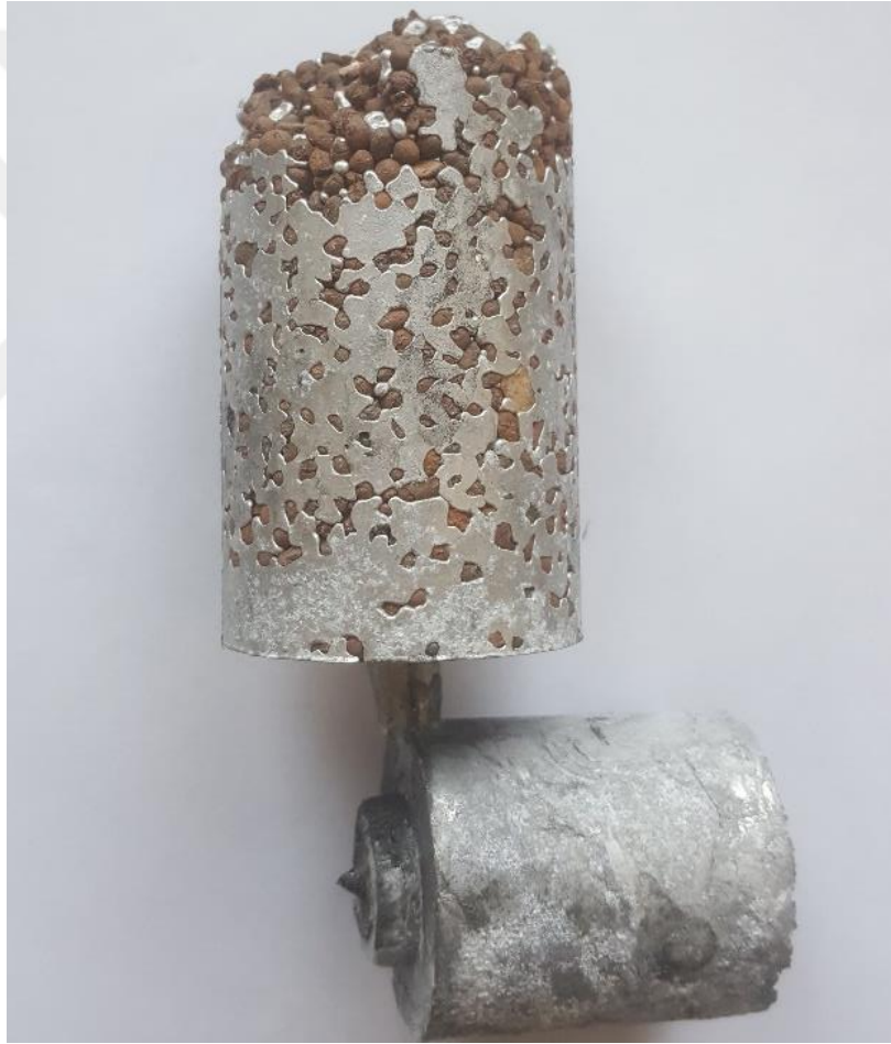
Şekil 4.3: Düşük küre sıcaklığı sebebiyle tam dolum sağlanamamış bir numune.
