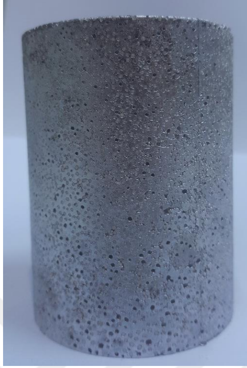
Şekil 2.6: Alüminyum ve genişletilmiş cam kullanılarak üretilmiş bir sintaktik köpük metal.
