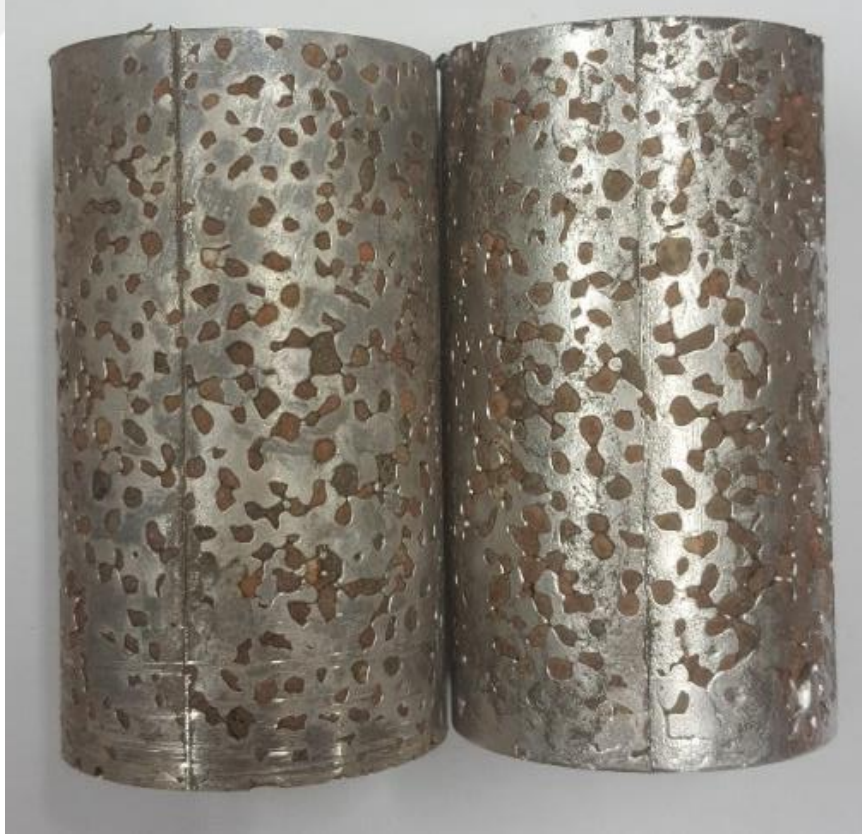
Şekil 4.12: Isıl işlem uygulanmış (solda) ve uygulanmamış (sağda) birer numune (önden).
