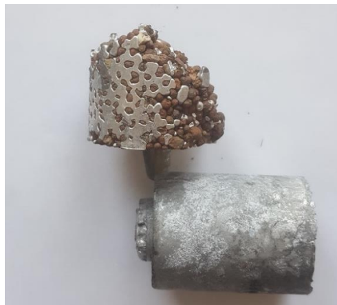
řekil 4.2: Dřk hız sebebiyle dolumun gerekleřmedięi bir numune.
