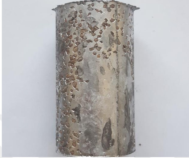
řekil 4.1: Yksek basın sebebiyle arzu edilenden fazla alminyum ieren numune.
