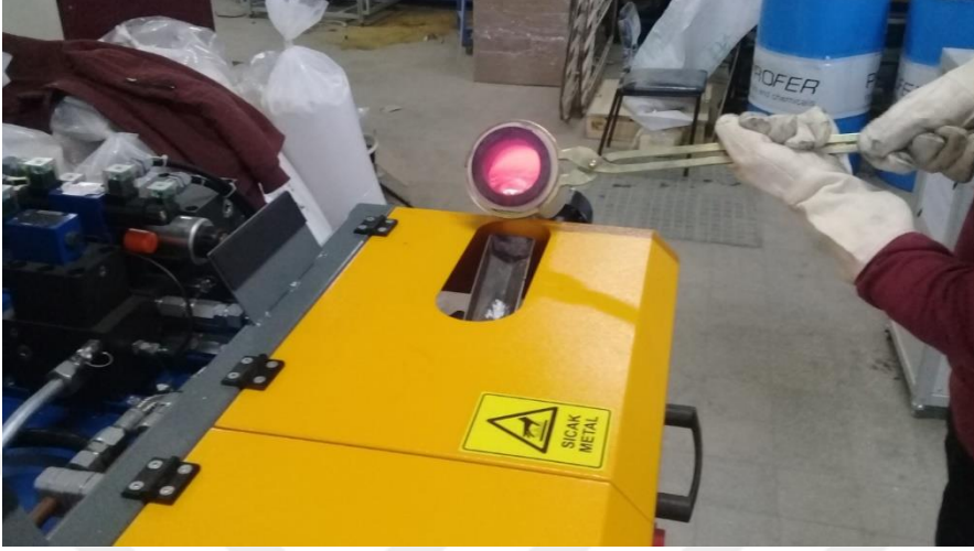
Şekil 3.8: Makine yolluğuna eriyik madenin dökülmesi.
