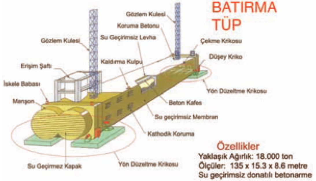
Şekil 4.2: Marmaray Tüp Boğaz Tüp Geçidi Kesit Şeması[23]
