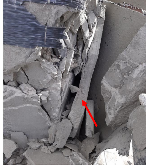
Şekil 3.32 : Tamir harcının kademeli uygulaması sonucu oluşan tabakalaşma.
