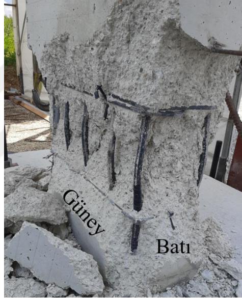
Şekil 3.27 : Test sonrasında boyuna donatılarda görülen burkulmalar.
