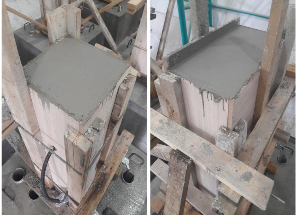
Şekil 2.2 : Numune üst yüzeyinin perdahlanması.
