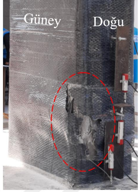
Şekil 3.36 : +0.075 görelî ötelemede LP kumaş üzerindeki yırtılmalar ve tamir harcı parçalanması.
