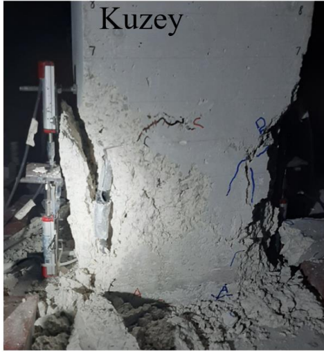
Şekil 3.7 : +0.015 görelî ötelemede kolon yüzeylerinde gelişen çatlaklar.
