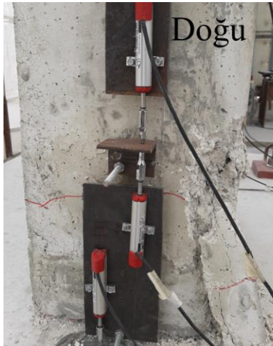
Şekil 3.25 : +0.05 görelî ötelemede kolon yüzeylerinde gelişen çatlaklar.
