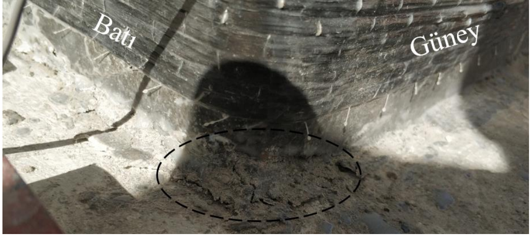
Şekil 3.19 : +0.015 görelî ötelemede kolon-temel birleşiminde, (a) tamir harcı yüzeyinde kısmî ezilmeler, (b) ayrılımların genişlemesi.
