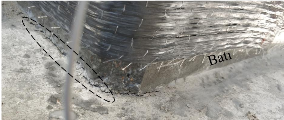
Şekil 3.18 : +0.01 görelî ötelemede kolon-temel birleşiminde mikro çatlak oluşumu.
