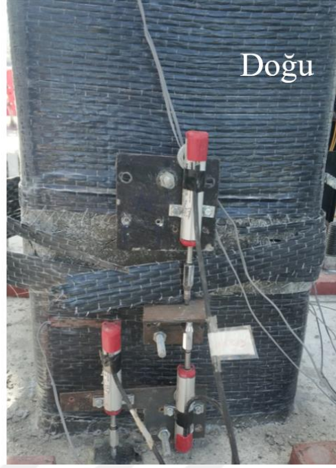
Şekil 3.21 : +0.03 görelî ötelemede LP kumaş üzerindeki yırtılmalar.
