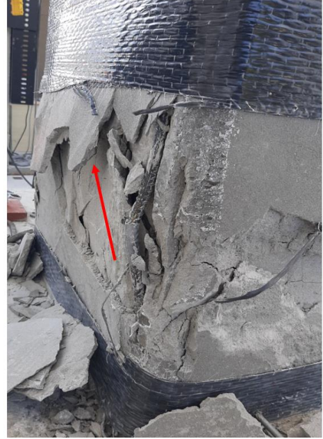
Şekil 3.37 : Tamir harcının kademeli uygulaması sonucu oluşan tabakalaşma.
