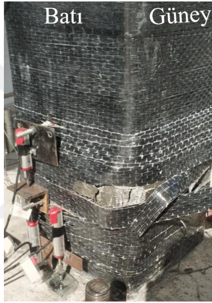
Şekil 3.13 : +0.02 görelî ötelemede LP kumaş üzerindeki yırtılmalar.
