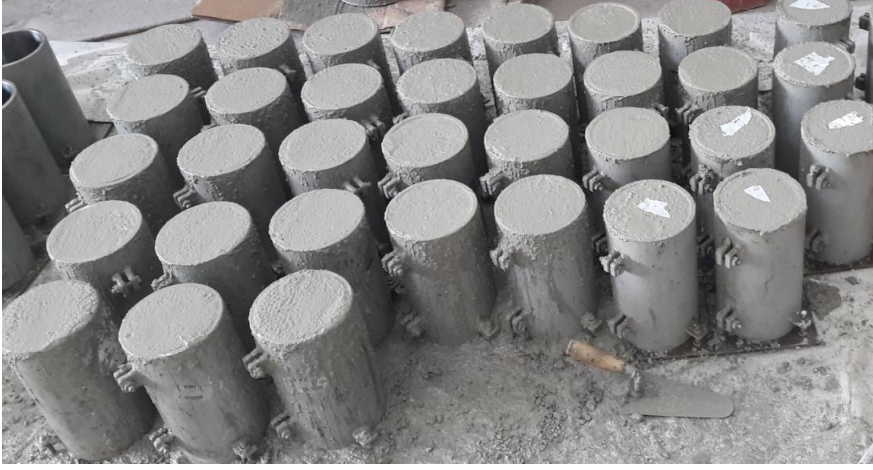
Şekil 2.3 : Silindir numunelerin dökümü.
