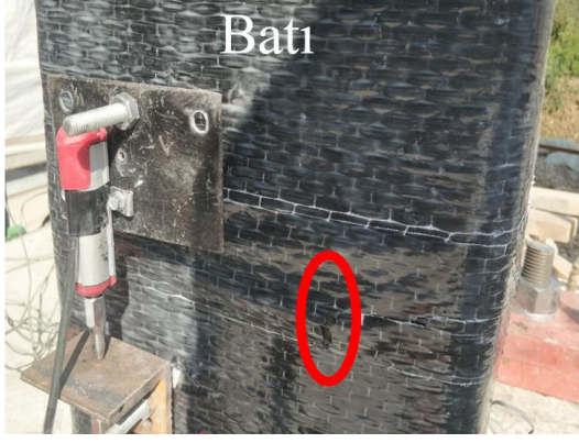
Şekil 3.12 : +0.015 görelî ötelemede LP kumaş üzerindeki gözlenen gerginleşmeler.
