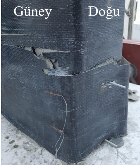
Şekil 3.31 : +0.075 görelî ötelemede LP kumaş üzerindeki yırtılmalar ve tamir harcı parçalanması.
