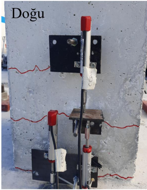
Şekil 3.4 : -0.05 görelî ötelemede kolon yüzeylerinde gelişen çatlaklar.
