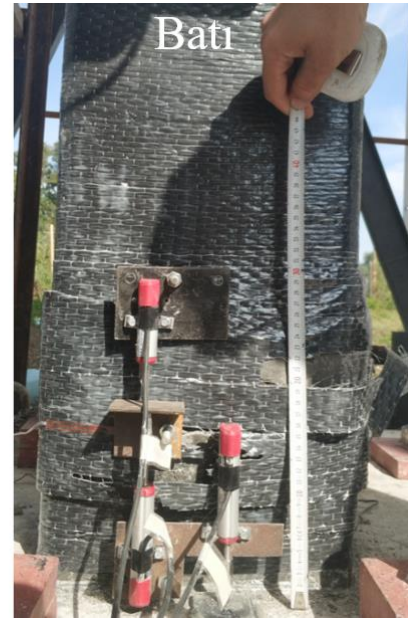
Şekil 3.13 : +0.02 görelî ötelemede LP kumaş üzerindeki yırtılmalar.
