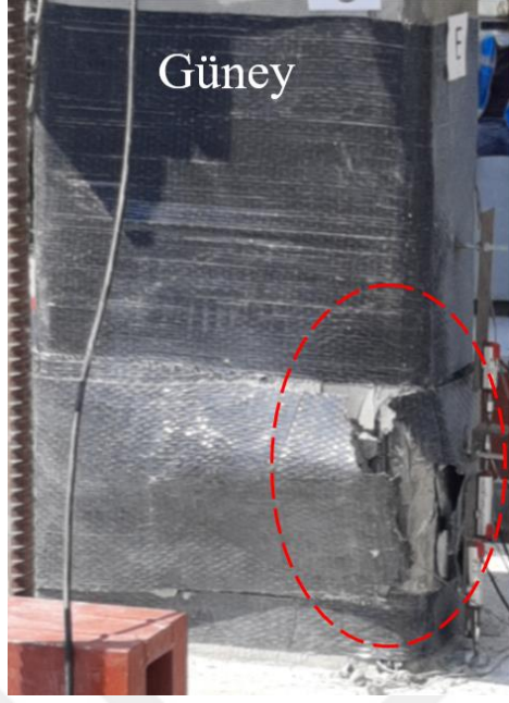
Şekil 3.36 : +0.075 görelî ötelemede LP kumaş üzerindeki yırtılmalar ve tamir harcı parçalanması.
