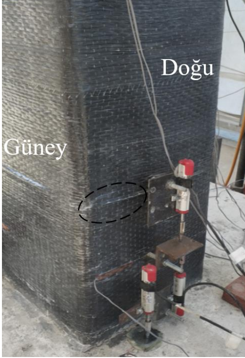
Şekil 3.20 : -0.02 görelî ötelemede LP kumaş üzerinde gözlenen gerginleşmeler.
