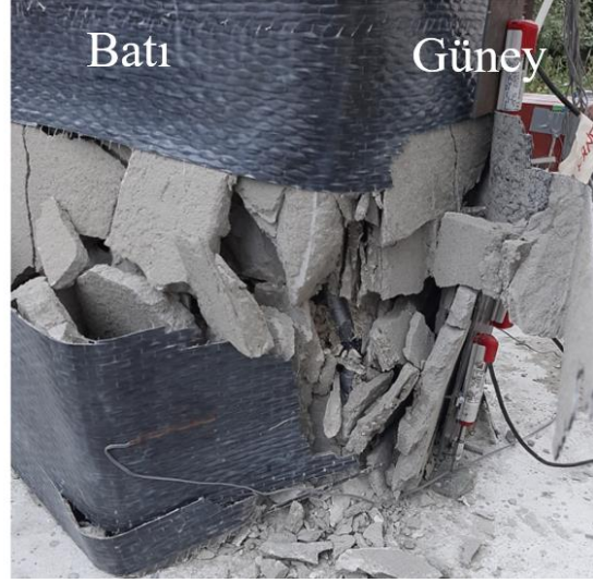
Şekil 3.31 : +0.075 görelî ötelemede LP kumaş üzerindeki yırtılmalar ve tamir harcı parçalanması.
