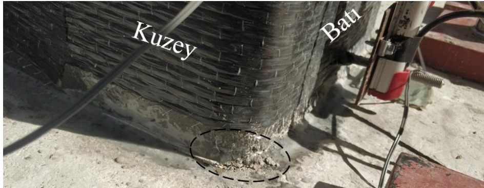
Şekil 3.18 : +0.01 görelî ötelemede kolon-temel birleşiminde mikro çatlak oluşumu.
