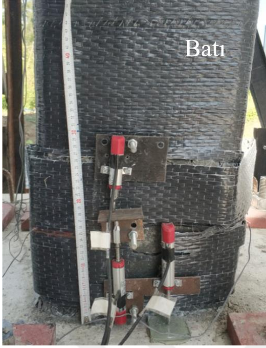
Şekil 3.21 : +0.03 görelî ötelemede LP kumaş üzerindeki yırtılmalar.
