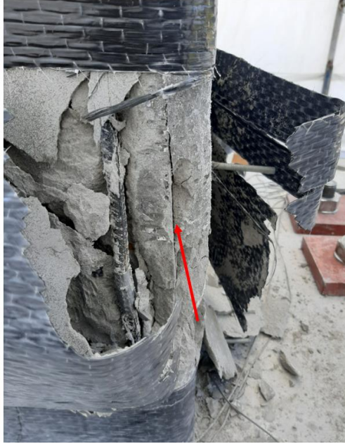
Şekil 3.37 : Tamir harcının kademeli uygulaması sonucu oluşan tabakalaşma.
