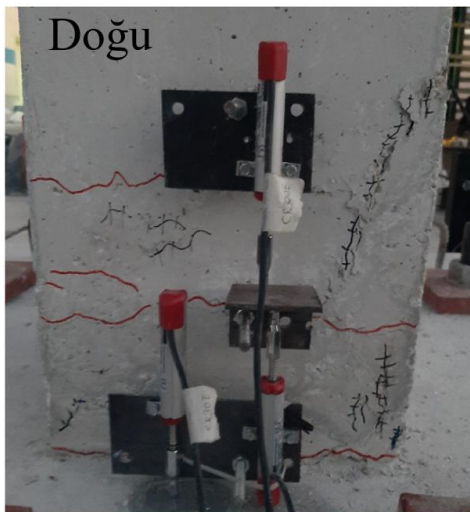
Şekil 3.6 : +0.01 görelî ötelemede kolon yüzeylerinde gelişen çatlaklar.
