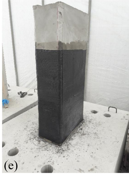
Şekil 2.8 : Methodun uygulanma adımları, a) güçlendirme öncesi, b) paspayının temizlenmesi, c) ilave boyuna donatıların ankrajı, d) tamir harcı uygulanması, e) CFRP sargılama.
