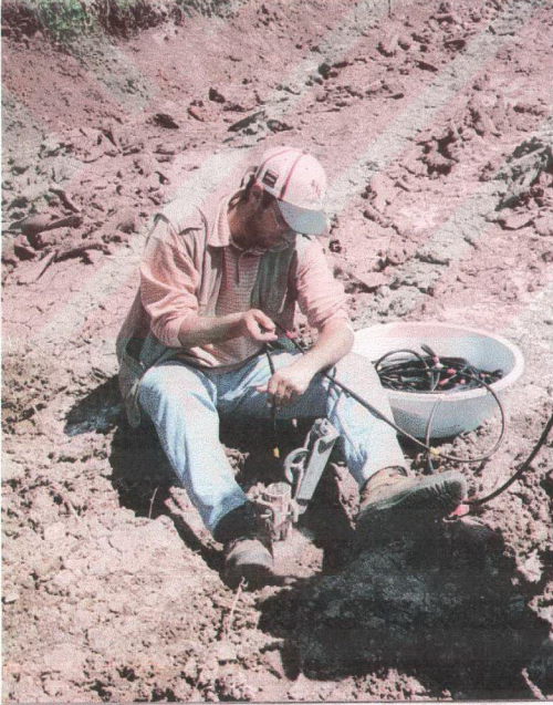
Fotoğraf 4.5 Taşaltı heyelan bölgesindeki inklinometre ölçümleri
