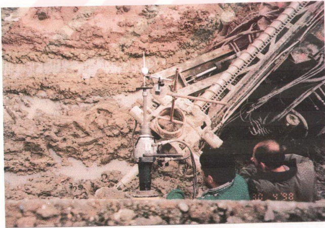
Fotoğraf. 5.5 DYWIDAG ankrajlara uygulanan 45 tonluk gerilme testleri
