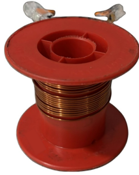
Şekil 3.11 : Hava boşluklu çekirdekli endüktans.
