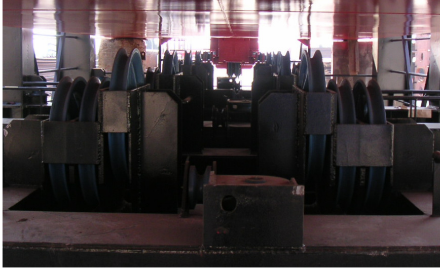
Şekil 2.18 : Araba üzerinde makaraların yerleşimi
