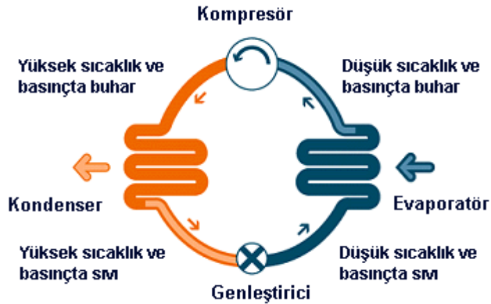
Şekil 2.1 Buhar Sıkıştırımlı Soğutma Çevrimi [2]
