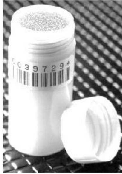
Şekil 7.1 : Radon gazı ölçümlerinde kullanılan radon test tüpü.
