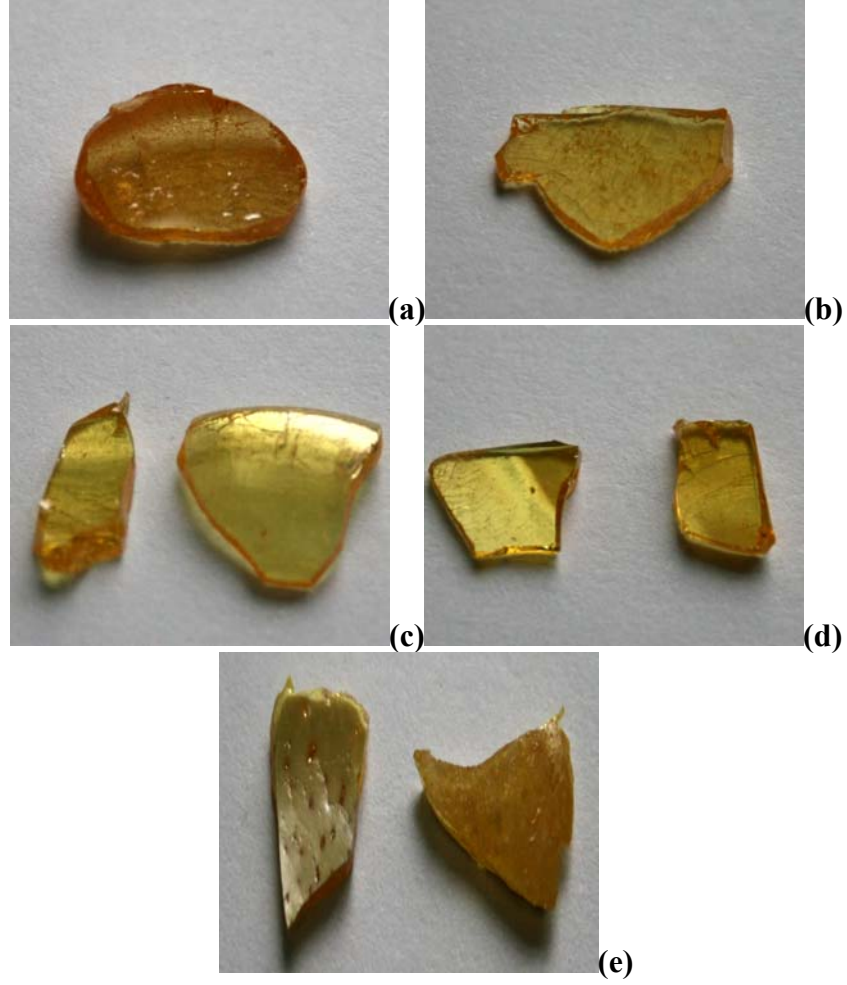
Şekil 6.7 : Döküm Sonrası Cam Yapan Numunelerin Makro Fotoğrafları a) x = 0,10 , b) x = 0,15 , c) x = 0,20 , d) x = 0,25 , e) x = 0,30
