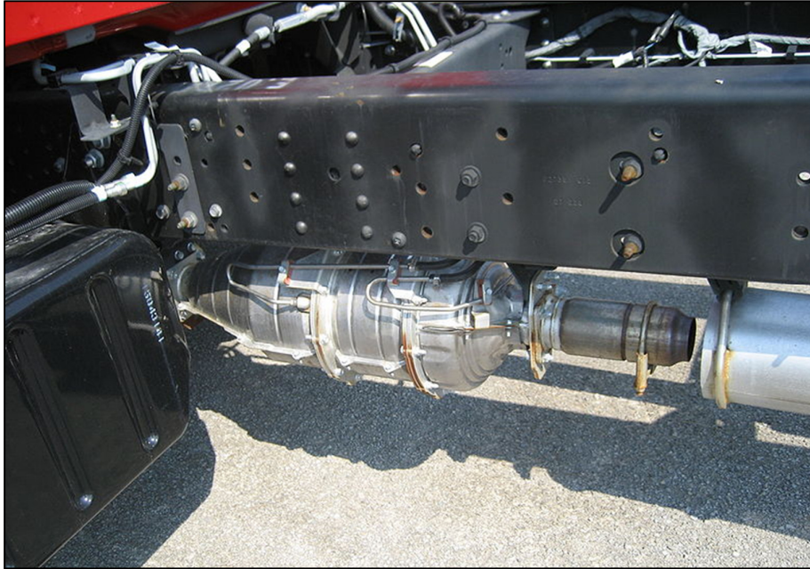
Şekil 9.1 : DPF sisteminin araç üzerindeki görünümü [32].
