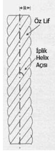
Şekil 2.4: Ring iplik yapısının şematik diyagramı
