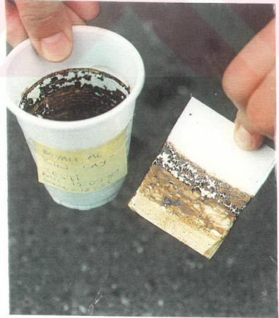
řekil 7.18. ayda bekletilmiř saf, eloksallı ve toz boyalı alüminyum örnekleri
