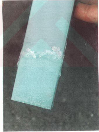
Şekil 7.11. Deniz suyunda bekletilmiş saf, eloksalı ve toz boyalı alüminyum örnekleri
