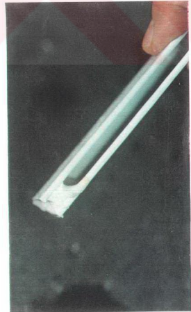
Şekil 7.12. Alçıda bekletilmiş saf, eloksalı ve toz boyalı alüminyum örnekleri
