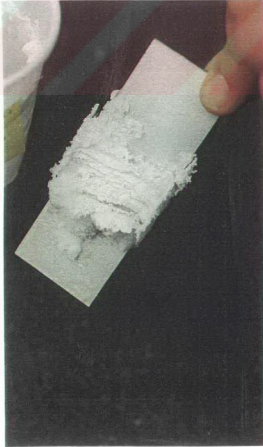
Şekil 7.15. %5'lik \text{Na}_2\text{CO}_3 çözeltisinde bekletilmiş saf, eloksallı ve toz boyalı alüminyum örnekleri
