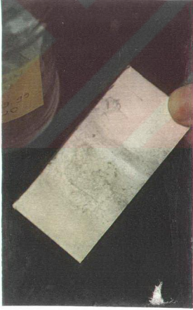
Şekil 7.11. Deniz suyunda bekletilmiş saf, eloksalı ve toz boyalı alüminyum örnekleri
