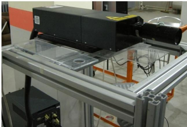
**Figure 2.14** : Dual Cavity Nd:Yag Laser.
