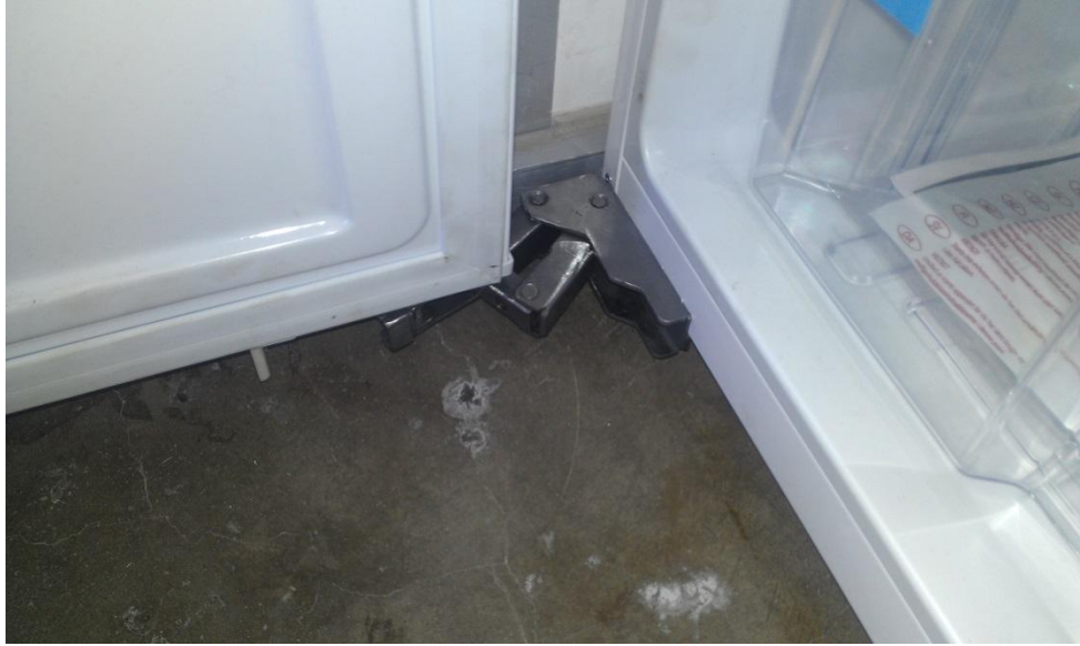
Şekil 6.27 : CNC tezgahında imal edilen menteşe.
