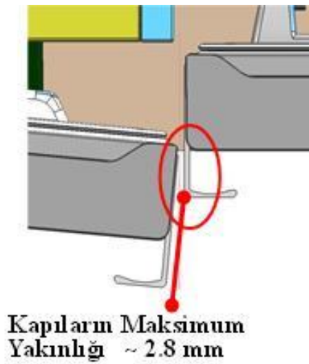
Şekil 5.16: Soğutucu ve dondurucu kapılarının yakınlığı.
