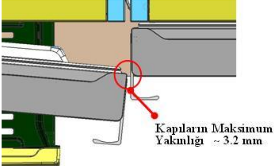
Şekil 5.19: Kapıların birbirine yaklaşma mesafesi.
