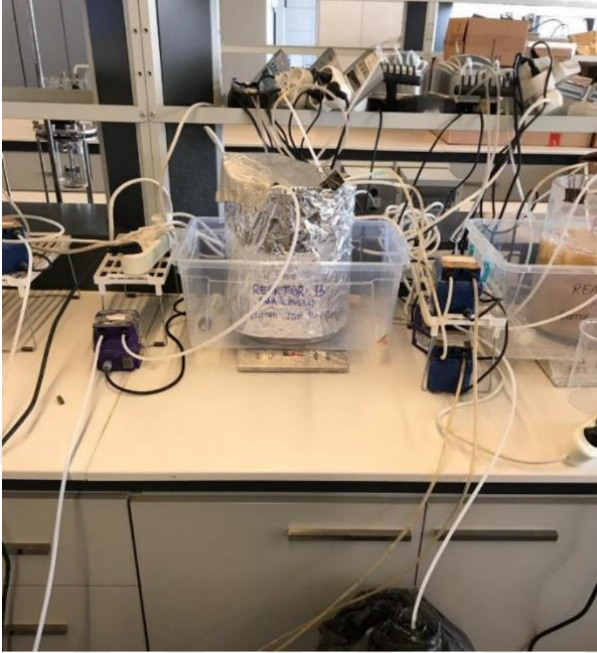
Şekil 4.2 : Mikrokirlletici ilaveli reaktör
