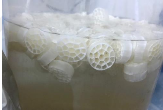
Şekil 3.4 : Reaktörlere ilave edilen dolgu malzemesinin boşaltma anındaki pozisyonu
