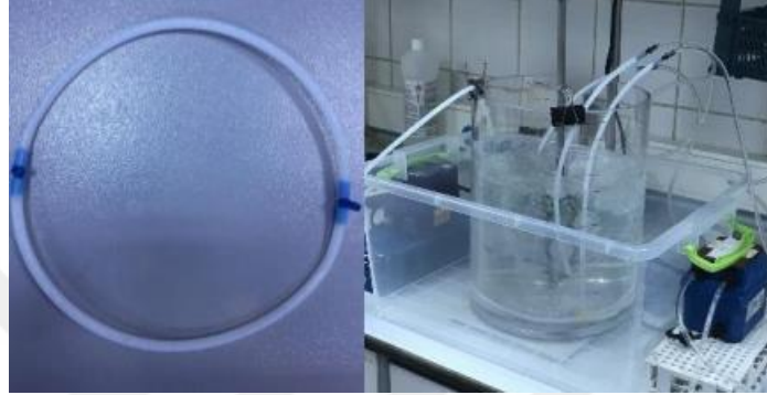
Şekil 3.2 : Teflon malzemeden yapılmış havalandırma boruları
