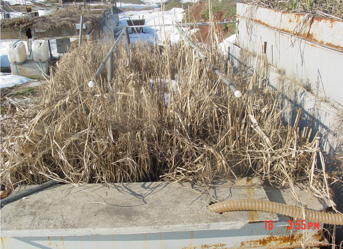
Foto D.6: 10 m 2 'lik sistemde 1.reaktörden 2.reaktöre atıksu beslemesi
