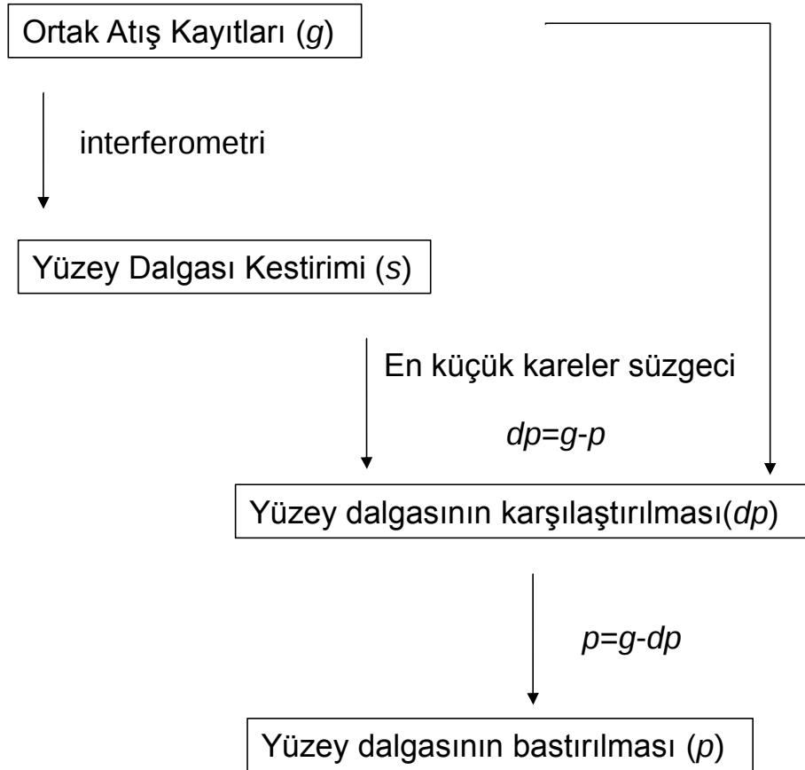
Şekil 3.12 : Sismik interferometri yöntemi ile yüzey dalgalarının bastırılması yönteminin şeması.
