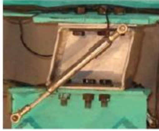
Şekil 2.2 : Kesme yükü altında eksenel kuvvetlere maruz kalan kayma bağlantısı (Sahoo ve Rai, 2010).
