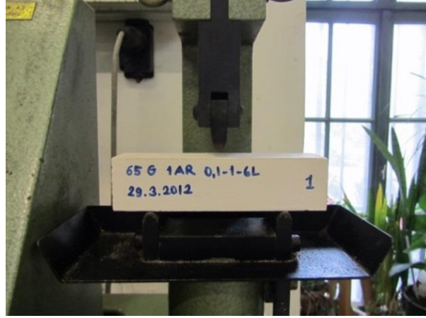
Şekil 3.14 : Eğilme presi ve 4x4x16 cm boyutlu prizmatik alçı numune.
