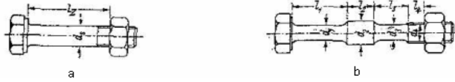
Şekil 4.6 Yaylanma rijitliğinin hesabı a. cıvatanın b. uzar cıvatanın
