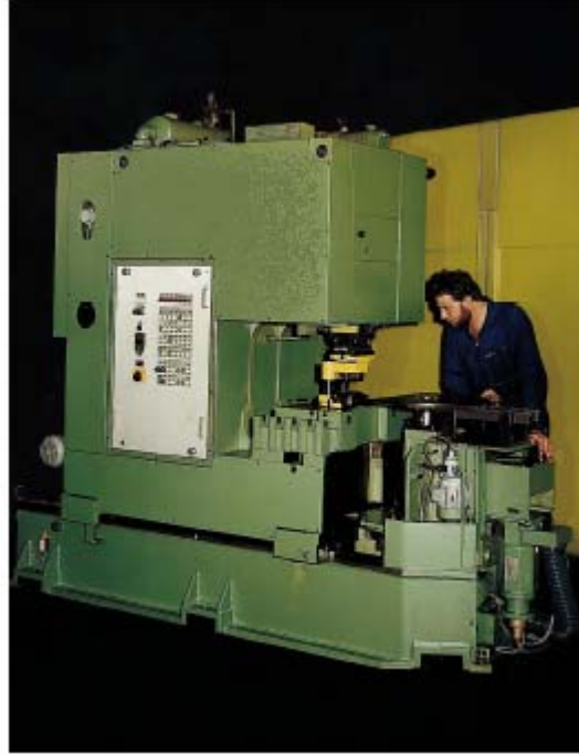
Şekil 2.1 250 tonluk dairesel kesitli parçalar için kesme presi
