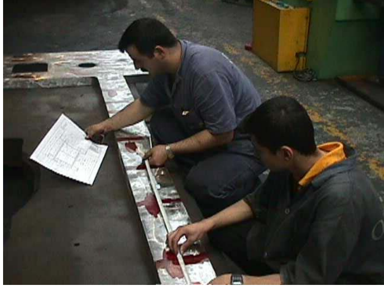
Şekil 3.6 Alt gövdenin alt plakasının montaj için markalanması
