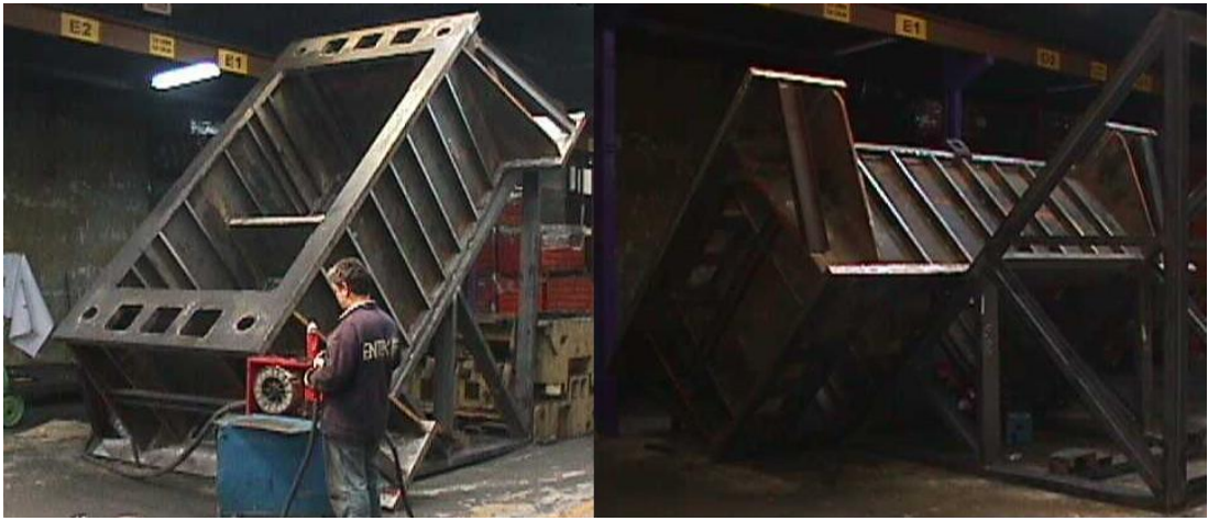
Şekil 3.10 Alt gövdenin fikstürde farklı pozisyonlarda konumlandırılması
